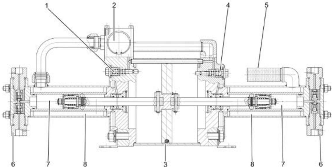
Fig. MAXIMATOR booster Type DLE 15
